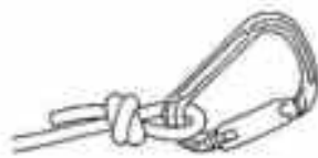
Рисунок 20. Барелл (полугрейпвайн удавка)
